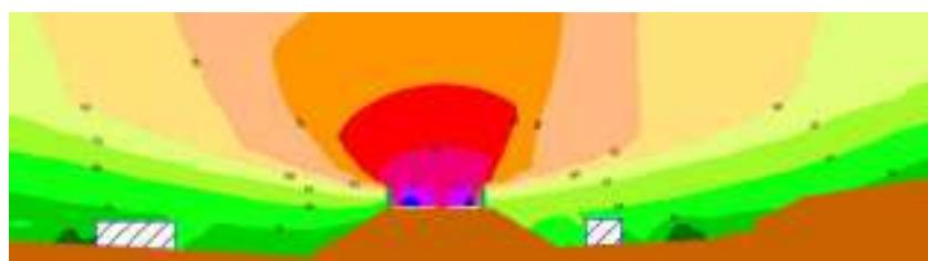
*Poprečni presjek nasipa sa izofonama i panelom za zaštitu od buke*
