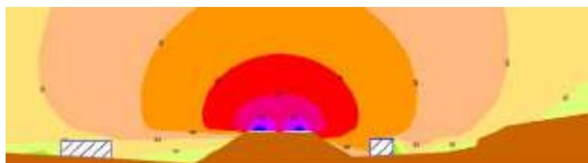
*Poprečni presjek nasipa sa izofonama bez mera zaštite od buke*
